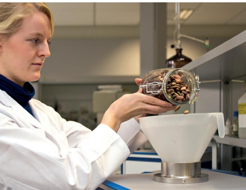
Produktproben müssen für das Mikrowellenresonanz-Verfahren nicht speziell aufbereitet werden
